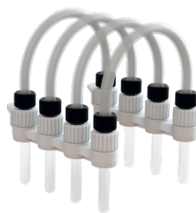
Vapor Diffusion set-up
